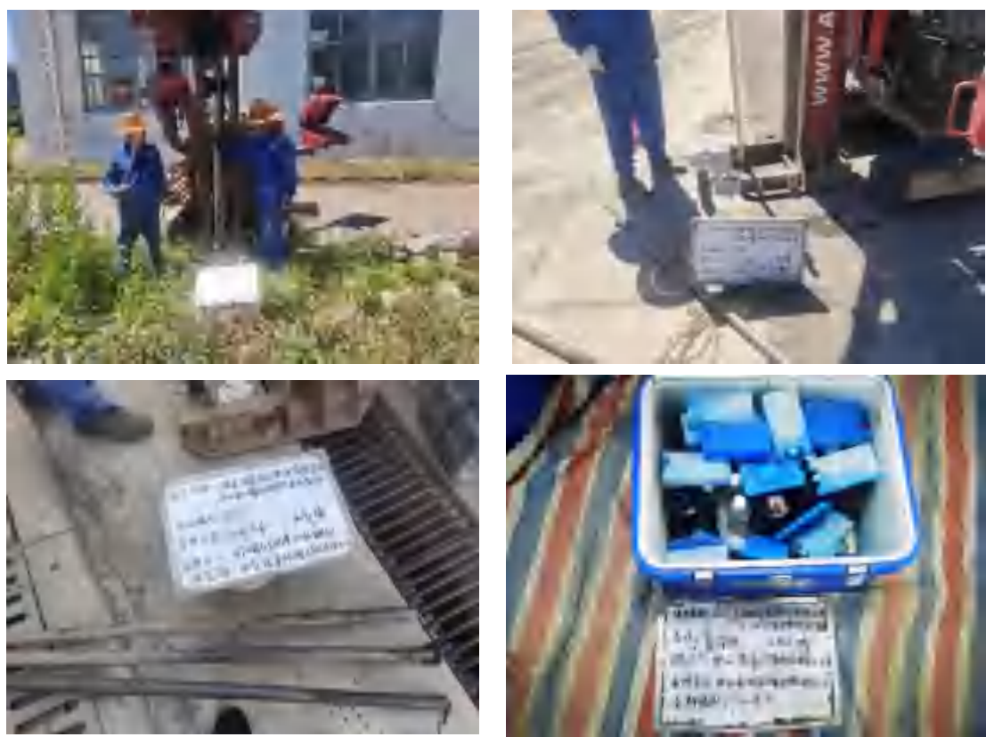
图 4.2-1 土壤钻孔采样照片
